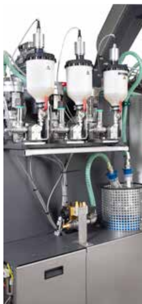
Farb- und Additivdosierung
